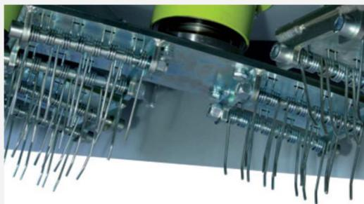
BM20 è stata sviluppata per le lavorazioni di inserimento o rimozione dell'intaso nelle fasi di installazione o manutenzione di manti in erba sintetica. La macchina si muove su 4 rulli di appoggio regolabili in altezza che permettono di scegliere la profondità di lavoro più opportuna. I rotori possono essere equipaggiati con molle o spazzole lineari in PPL. Applicazione posteriore a trattori con una potenza minima di 30Hp.
