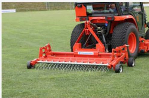
Decompattatore adatto per applicazione a trattrici (18 kW) con attacco a 3 punti CAT I e CAT 0.
