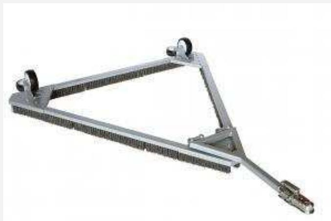
Spazzatrice a forma triangolare con telaio autoportante, spazzole lineari in PPL (polipropilene) e gancio traino a sfera per una facile manutenzione del tappeto in erba sintetica. Un utilizzo costante consente di mantenere un intaso morbido ed omogeneo e allo stesso tempo rinvigorisce le fibre del manto erboso sollevandole e decompattandole.
