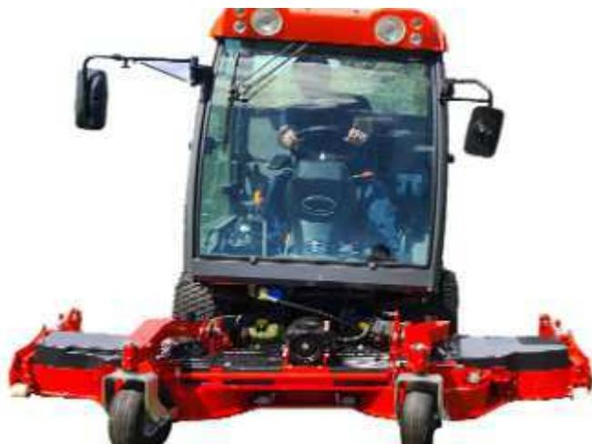
Recycling tosaerba con scarico posteriore per attacco frontale.
