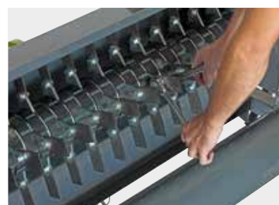
Lame facilmente sostituibili Easily replaceable blades Einfacher Messerwechsel Lames facilement remplaçables Cuchillas de fácil sustitución
